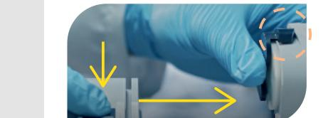
Luego, abra la **tapa de fijación** del **empujador** para permitir insertar la jeringa.
