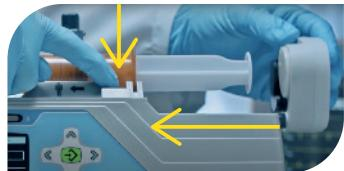
Luego, cierre la **tapa de fijación** del **empujador** hacia arriba para ajustar el **émbolo**.
