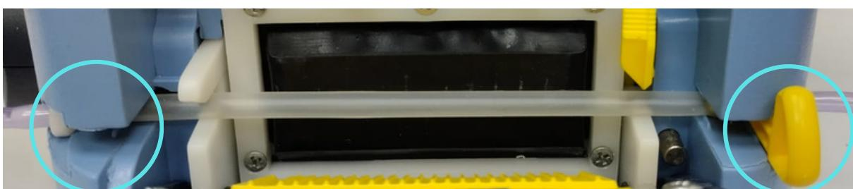
5. Purgar el descartable correctamente (manualmente o utilizando la purga del equipo), retirando todo el aire. Cerrar el regulador de flujo (Roller clamp) nuevamente, de este modo será evitada una situación de flujo libre (en el caso de llenado manual).
