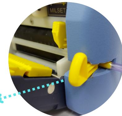
4. Coloque correctamente el descartable en la ranura, instalando los intermedios en sus cavidades correspondientes, con amarillo a la derecha y blanco a la izquierda, como se muestra en la imagen a continuación:
