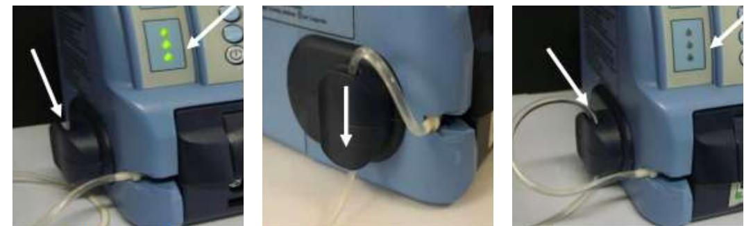
Luces indicando la inserción incorrecta o falta de descartable en la cavidad del sensor de aire en línea.
