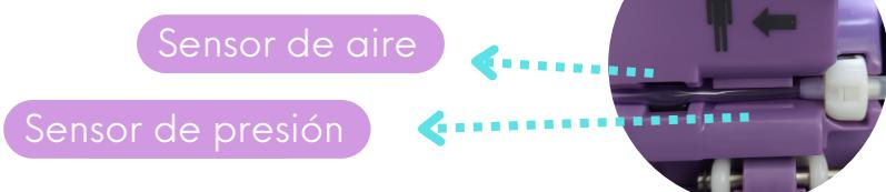
6. Coloque correctamente el tubo del descartable en los sensores de presión y aire, observando la dirección correcta del flujo y manteniendo la alineación correcta entre los puntos de conexión (corta-flujo descartable y sensor de aire).
