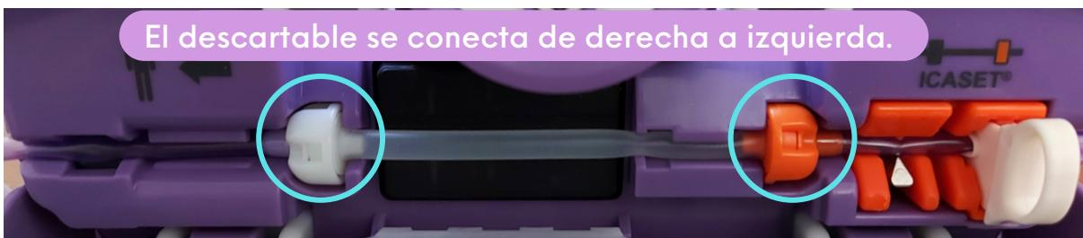
5. Coloque correctamente el descartable en la ranura, instalando los intermedios en sus cavidades correspondientes, con naranja a la derecha y blanco a la izquierda, como se muestra en la imagen a continuación:
